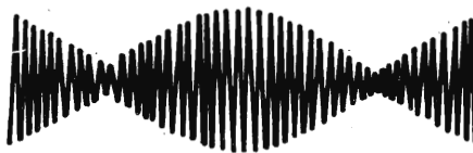
Fig. I.5 - Battimenti risultanti dalla composizione di due onde sinusoidali di frequenza leggermente diversa.
